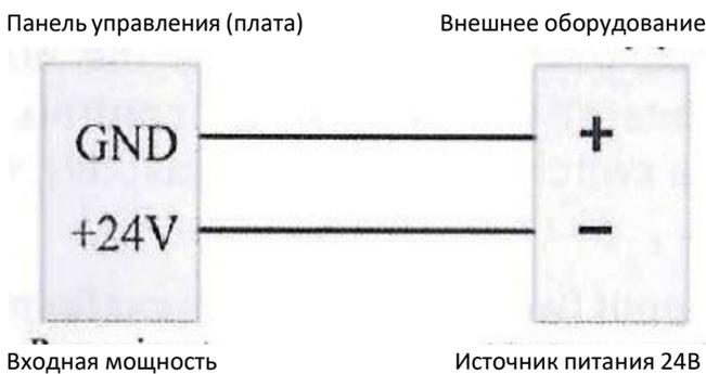
2. Подключение инфракрасного фотоэлектрического переключателя.
