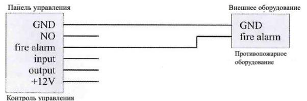
5. Соединение ввода/вывода с блокировкой двух устройств (ведущее/ведомое устройство может быть определено путем настройки параметров).
