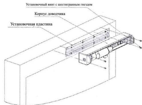
4. Установите корпус механизма, обращая внимание на положение и направление установленного внутри привода. Закрепите рычажную тягу на корпусе механизма доводчика и на дверном полотне соответствующим винтом М6 и зафиксируйте следующим образом:
