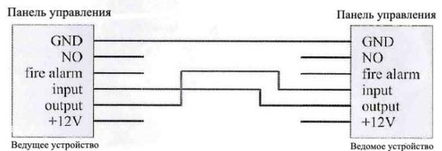
6. Подключение запирающего механизма к электромагнитному замку.
