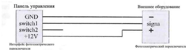
3. Подключение автоматического доводчика к оборудованию контроля доступа:
