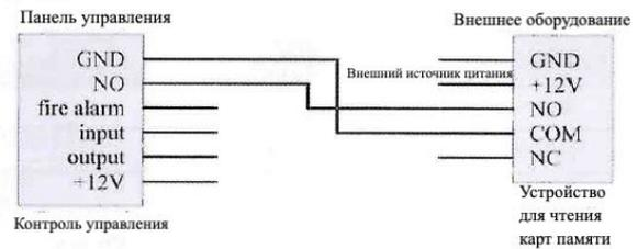
**ПРИМЕЧАНИЕ:** Все датчики открытия двери должны быть подключены к одной и той же точке (GND, NO).
