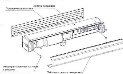
2. В соответствии со схемой монтажных размеров прикрепите установочную пластину электрического привода к дверной раме или стене с помощью крепежных элементов следующим образом:
