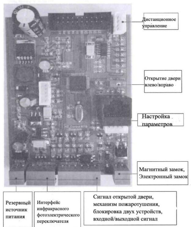
Основная панель (плата) управления и настройка параметров, описание функций:
